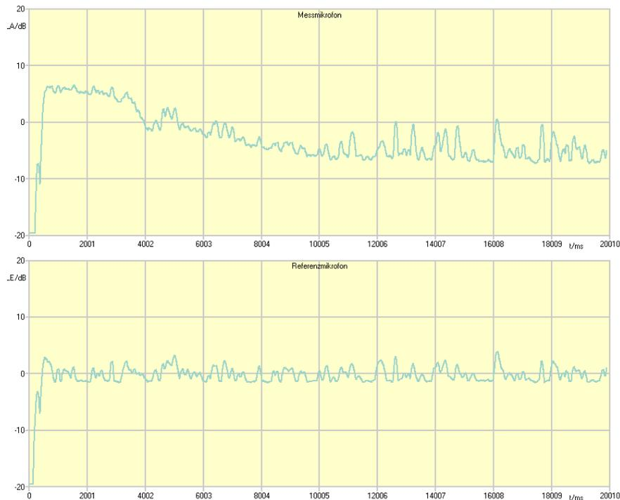
sehen Sie nun die Wirkung der Störschallunterdrückung. Sehr gut zu erkennen ist, dass die Erkennung rund 10 Sekunden braucht um ihre Wirkung zu entfalten. Im oberen Diagramm der Abbildung zu erkennen durch den abfallenden Teil der Kurve. Danach werden die Spitzen und Täler der Sprache (auch Dynamik genannt) wieder deutlich größer. Nicht mehr so groß wie in Abb. 20 – das würde ja bedeuten, dass das Rauschen völlig eliminiert wurde- aber um ca. 6- 8 dB. Dieser Zuwachs ist aus
