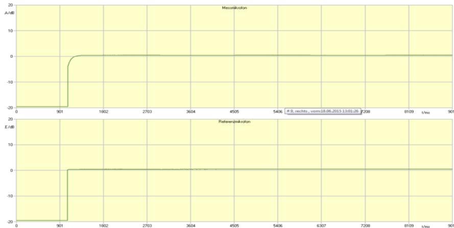
Abbildung 18: Pegel - Zeitdiagramm mit ausgeschalteter Rückkopplungsunterdrückung
